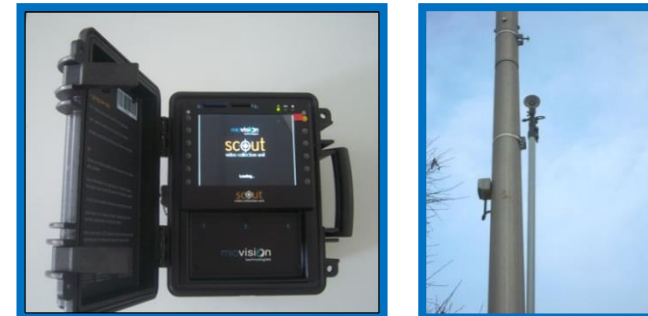
Mât de comptage avec caméra et boîtier d'enregistrement
